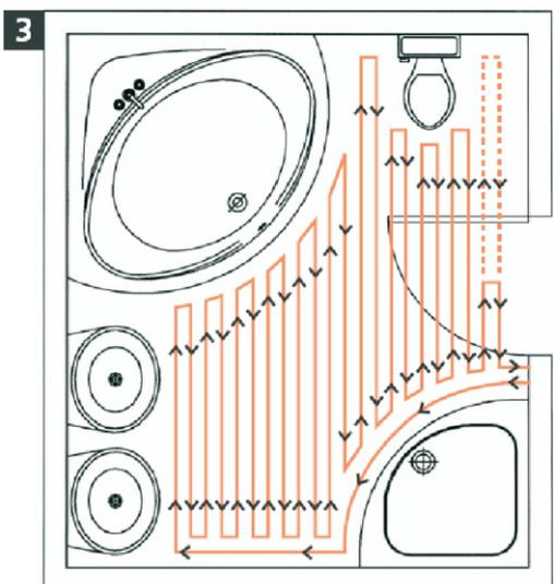
Sobald auf der Heizkabelrolle nur noch wenige Wicklungen zu erkennen sind, können Sie pro Wicklung eine Länge von etwa 40 cm veranschlagen (z.B.: 5 Wicklungen ergeben eine Heizkabel-Restlänge von ca. 2 m). Um Längendifferenzen des Heizkabels auszugleichen, verlegen Sie den Rest ohne Aluklebefolie.
